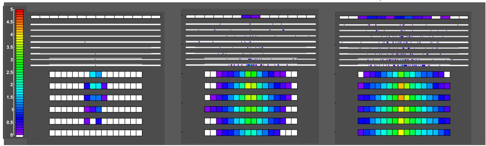
非常に厚い(30 r.l) カロリメータ(IMC+TASC)によるシャワー画像の可視化技術により、電子選別に必要な陽子除去性能を達成する。
